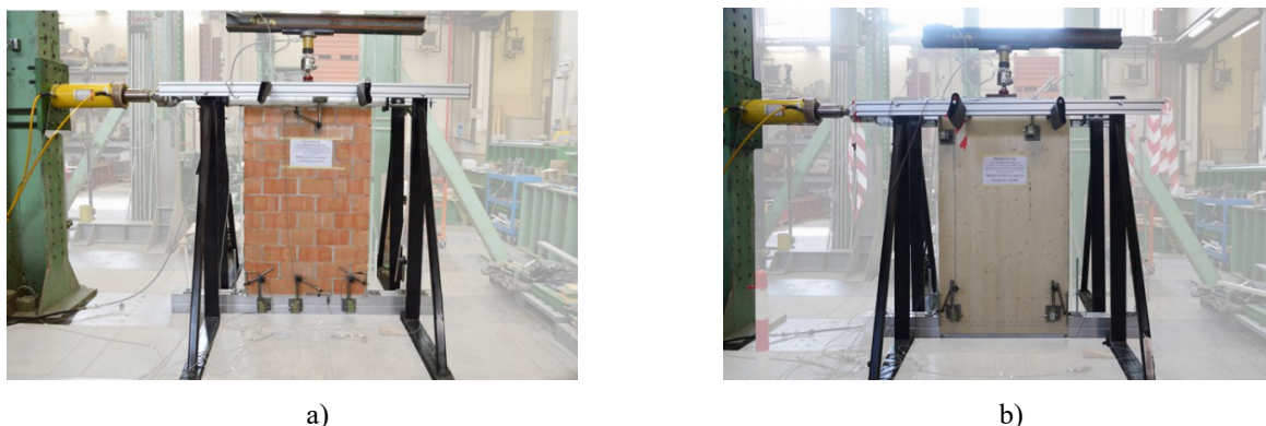
Fig. 1.4.7 Test sperimentali svolti all'Università degli Studi di Padova: a) pannello murario non rinforzato, b) pannello murario rinforzato (Pozza et al., 2017).
