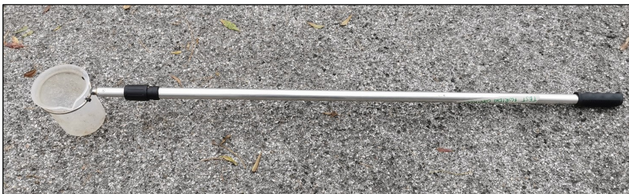
Figura 15: immagine che raffigura il dipper, ovvero lo strumento utilizzato per campionare le caditoie. Si può notare il becker saldato su un'estremità che consente di prelevare un volume d'acqua dove poter osservare l'eventuale presenza di larve di zanzara.
