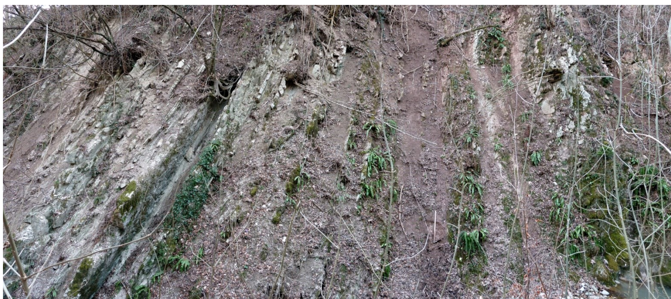
Fig. 6.5 – Intervallo prevalentemente marnoso affiorante tra circa 11 m e 20 m.
