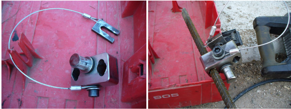
Foto n°14 e n°15, dispositivo di infissione per battute eccentriche.
