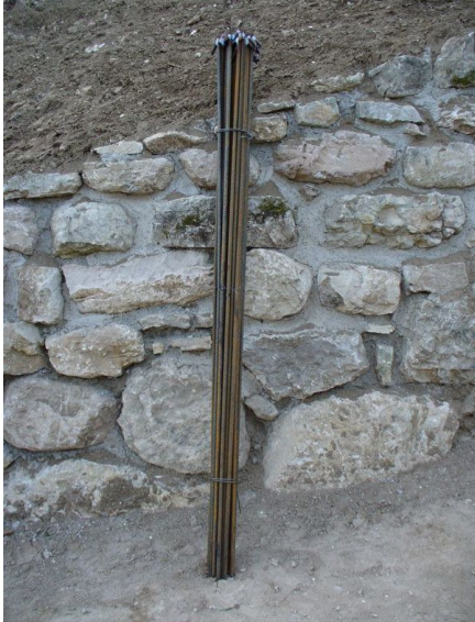
Foto n°10, barre ad aderenza migliorata nella versione con una delle estremità uncinata.
