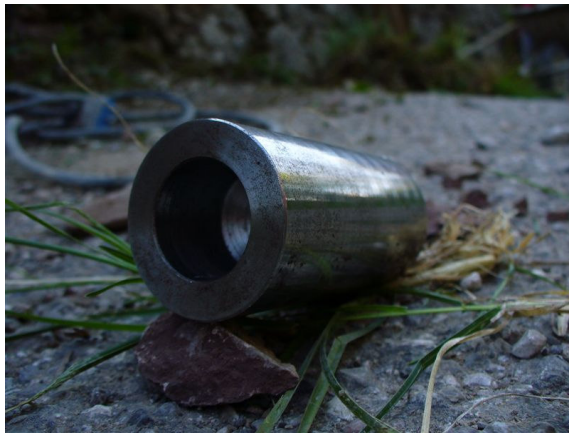
Foto n°13, dispositivo di infissione femmina/femmina.
