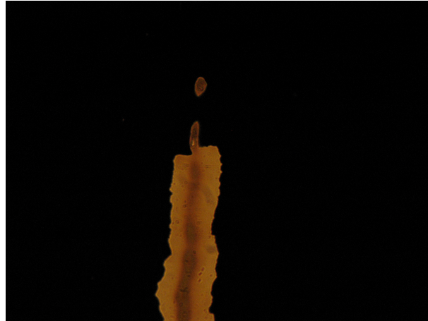
Figura 8.5: Foto dell'ablazione di CIGS-vetro con un impulso da 10\mu s e 15V : Lift-off. Parte scavata osservata con luce trasmessa
