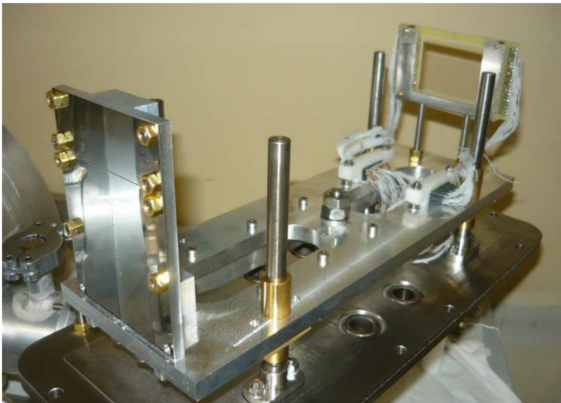
Figura 4.7 Sistema Fessura-Griglia del progetto SPES. (collimatore con fessura a sinistra, griglia di fili sulla scheda a destra)
