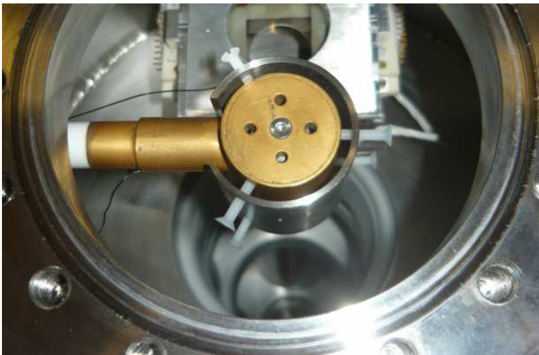
Figura 4.2 Faraday Cup con soppressore inserita nella traiettoria di fascio.
