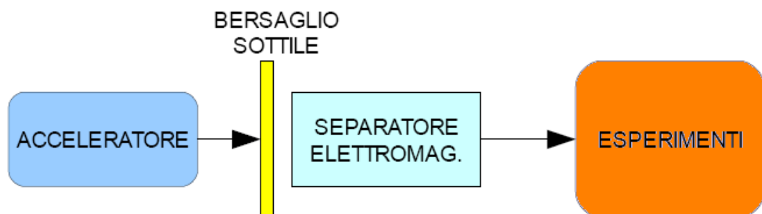
Figura 1.7 Rappresentazione schematica del metodo FRS
