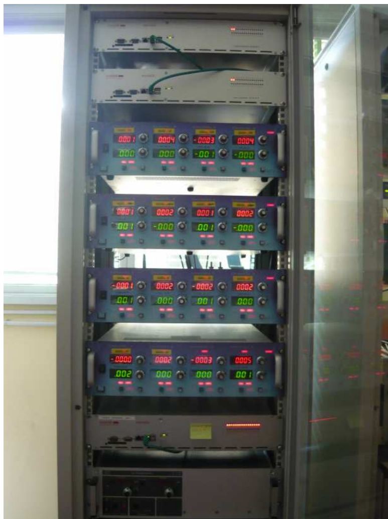
Figura 2.10 Il rack contenente gli alimentatori di alta tensione per deflettore, trippletto e camera target.
