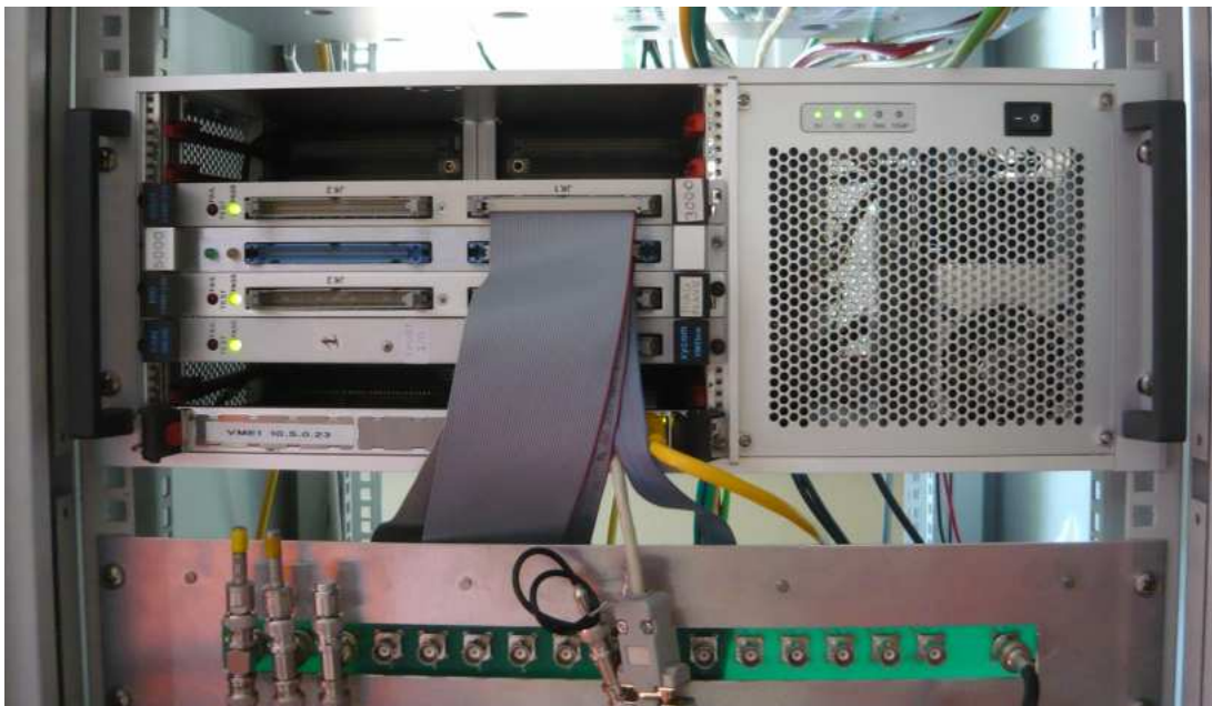
Figura 5.3 Crate VME e schede utilizzate
