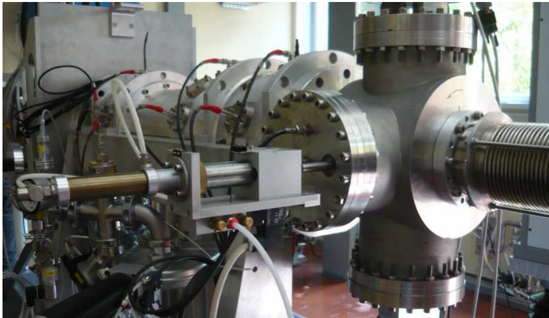
Figura 4.3 Sistema di movimentazione della Faraday Cup
