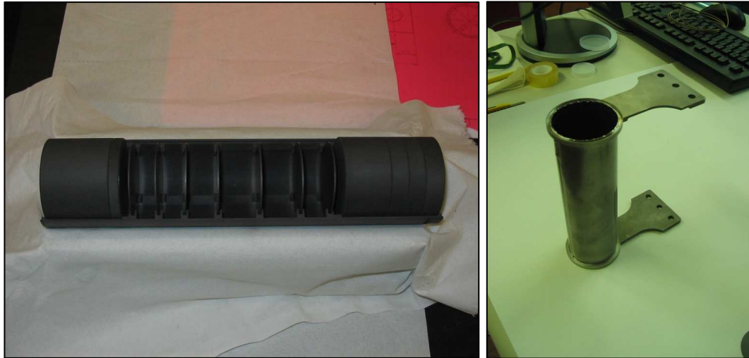
Figura 2.1 Prototipo di bersaglio diretto del progetto SPES, e del relativo riscaldatore.
