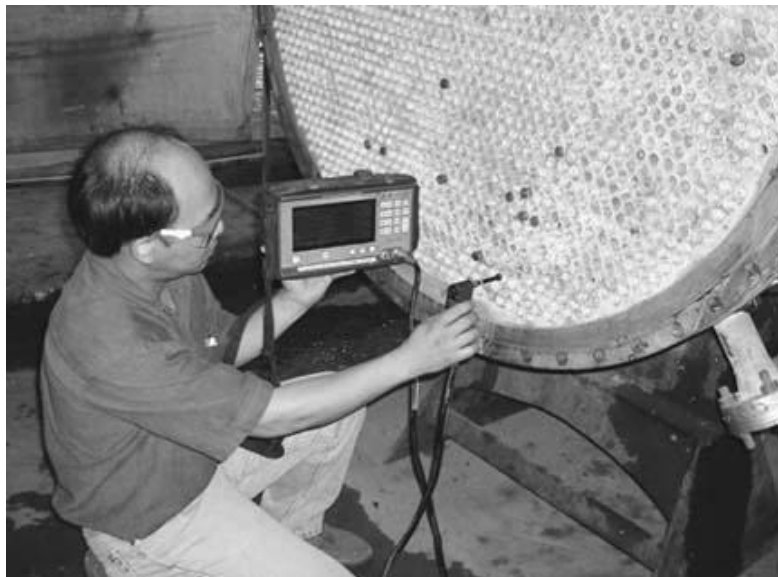
Fig.4.4.4 Test su piastra tubiera utilizzando una sonda rotante.
