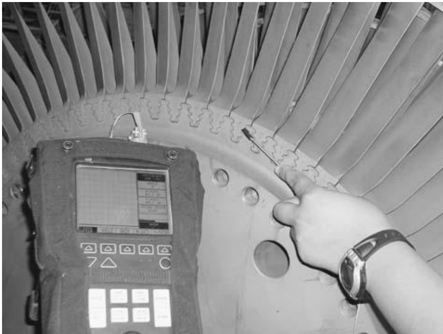
Fig. 4.4.7 Test sugli attacchi scanalati delle pale con metodo ET.
