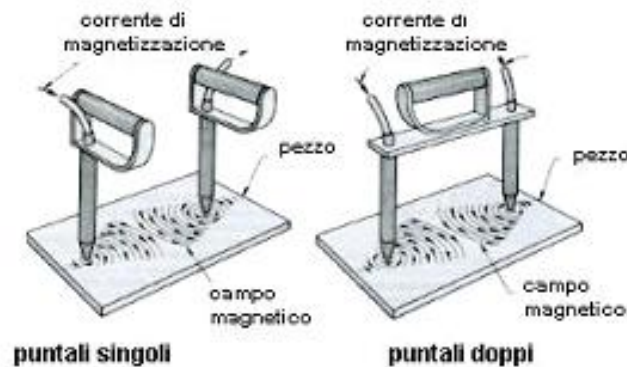
Fig.3.5.3 Esempi di magnetoscopio a puntali.
