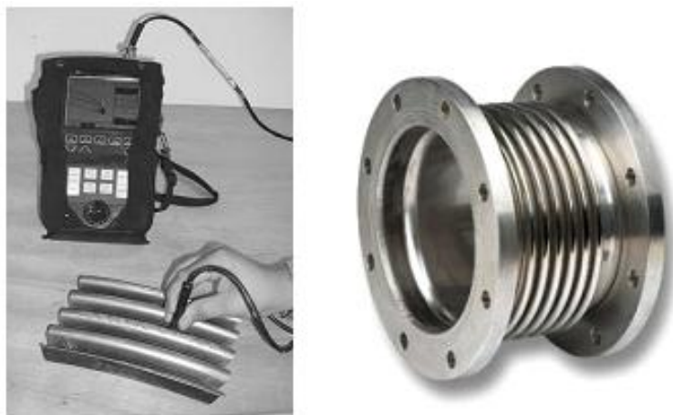
Fig. 4.4.6 Esempio di test ET su un soffietto.
