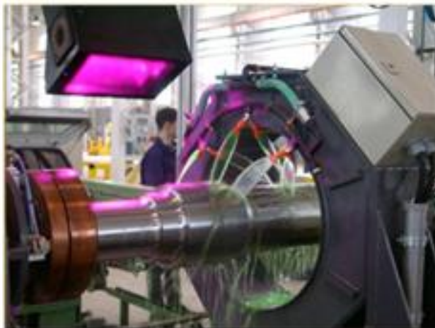
Fig.4.7.5 Esempi di MT con tecnica ad umido.
