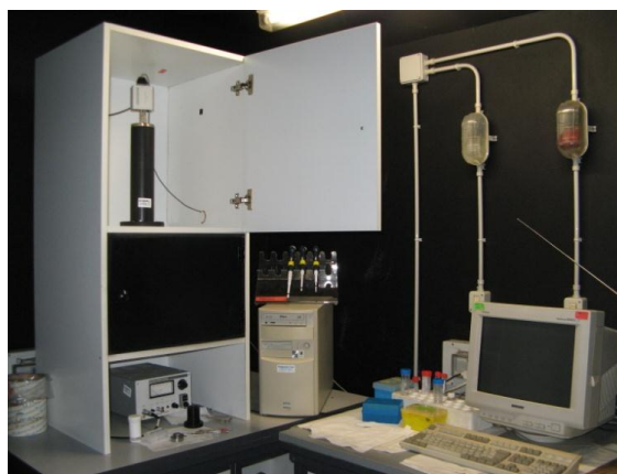
Fig.2.2 Luminometro adattato al sistema di misurazione della concentrazione di \text{Ca}^{2+} basato sull'equorina in colture cellulari in sospensione.
