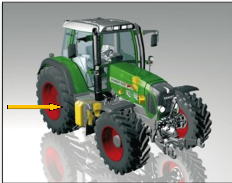
(Fig.17) componentistica del sistema di alimentazione a olio di colza del Fendt 820 Vario Greentec; notare la presenza di un serbatoio aggiuntivo per l'olio di colza.
