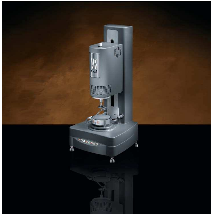
Figura 19 – Reometro rotazionale AR-G2.
