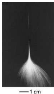
Figura 33: Apertura del getto principale di una soluzione acquosa di PEO ( t < 1\text{ms} ) [46]
