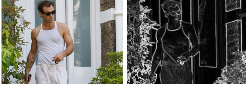
Figura 2.1: Immagine segmentata con gradiente morfologico con SE a diamante.
