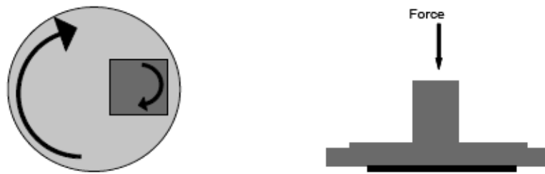
Figura 7. Rappresentazione dell'apparecchiatura per la lucidatura dei campioni vista da sopra (a sinistra) e il support del campione visto di lato (a destra).
