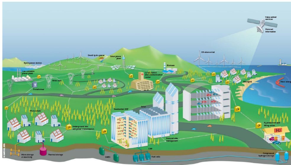
Figura 2: Struttura della futura rete di distribuzione: accanto ai grandi impianti di generazione tradizionali vi saranno gli impianti di generazione distribuita e da fonti rinnovabili e quelli di immagazzinamento dell'energia.
