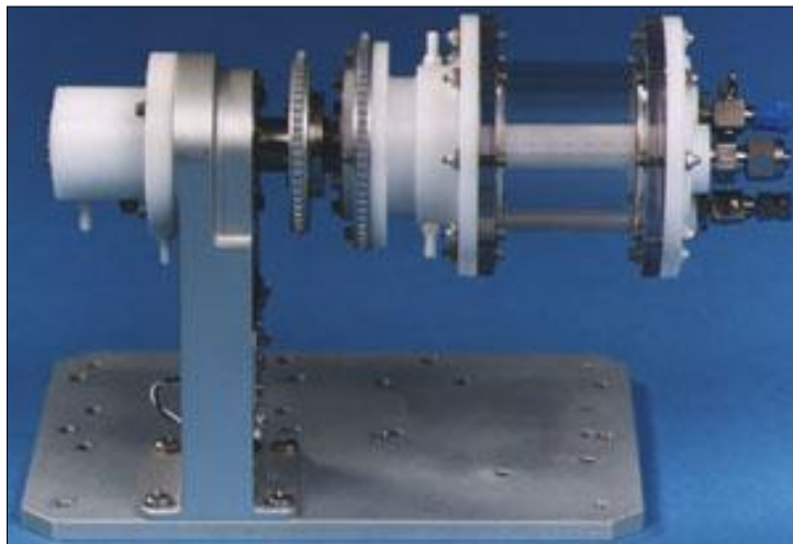
Figura 17 Bioreattore a parete rotante della NASA per l'ingegneria della cartilagine [28].
