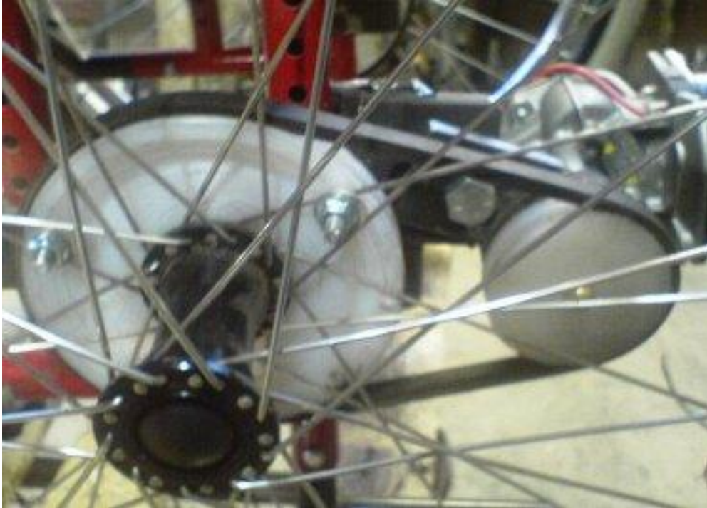
Fig. 10 particolare della cinghia e puleggia.
