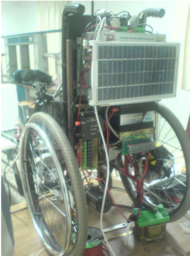
Fig. 77 Vista posteriore del modello Optichair I, computer di bordo e sistemi di potenza.
