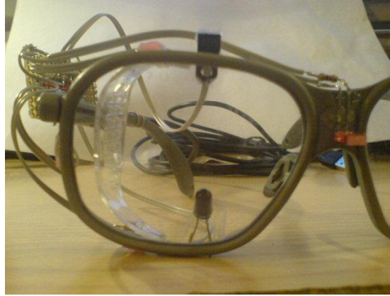
Fig 142 disposizione dei sensori e trasmettitori IR sull'occhiale
