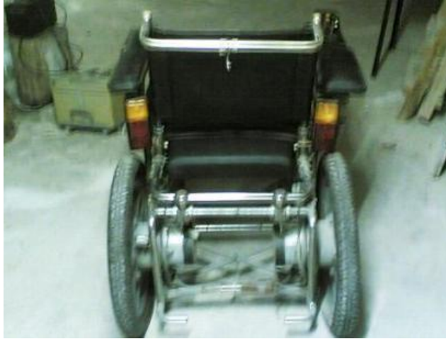
Fig. 39 motorizzazione e trasmissione Optichair II
