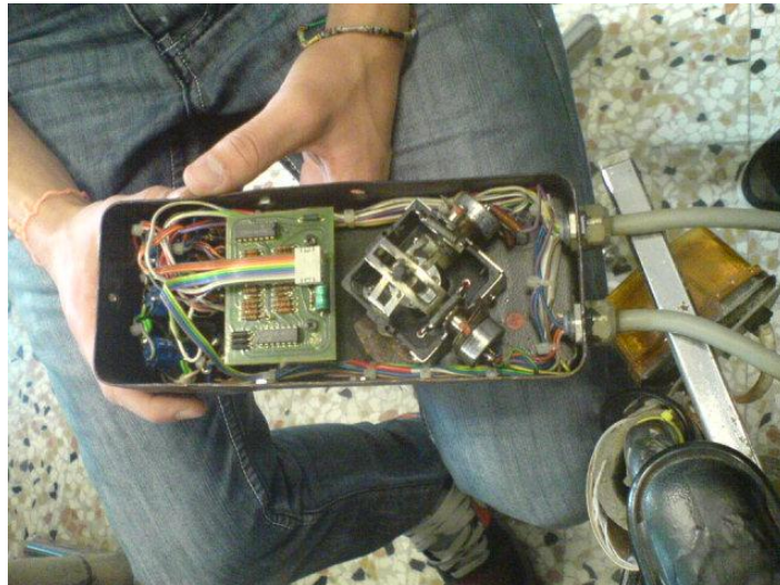
Fig 43 Particolare della centralina di controllo joystick (si notano i potenziometri X-Y)
