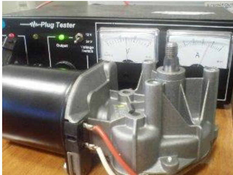
Fig. 13 Optichair I, assorbimento nella prova a vuoto.
