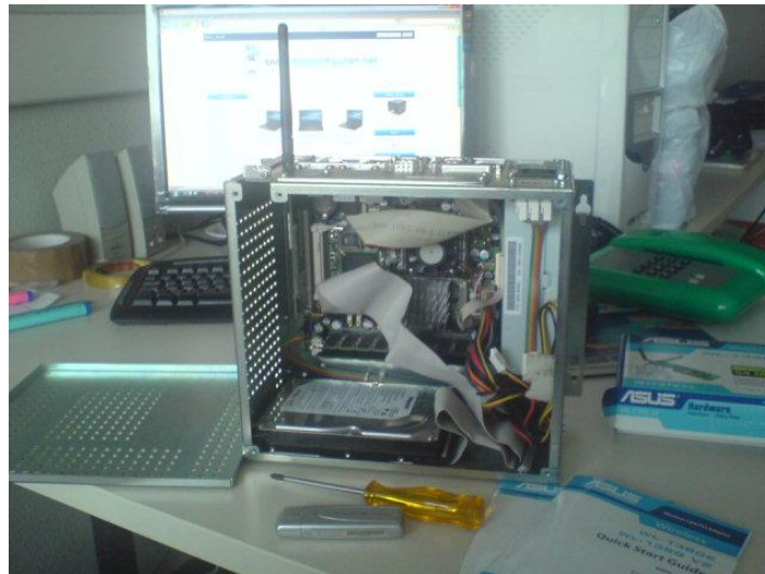
Fig. 15 Aspetto interno del computer di bordo.
