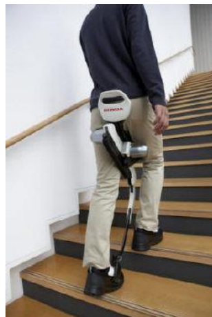
Fig 5 servoassistenza motoria in collaudo presso l'impianto Honda di Sayama, in Giappone. (© Honda)
