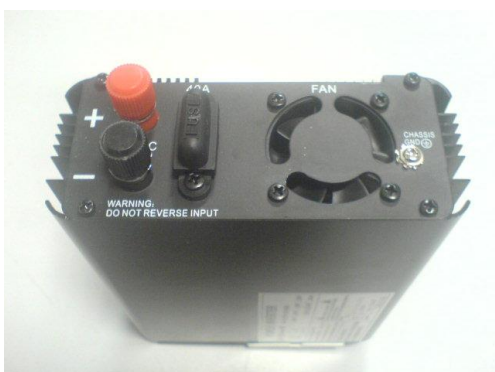
Fig. 34 entrata DC e ventola di raffreddamento
