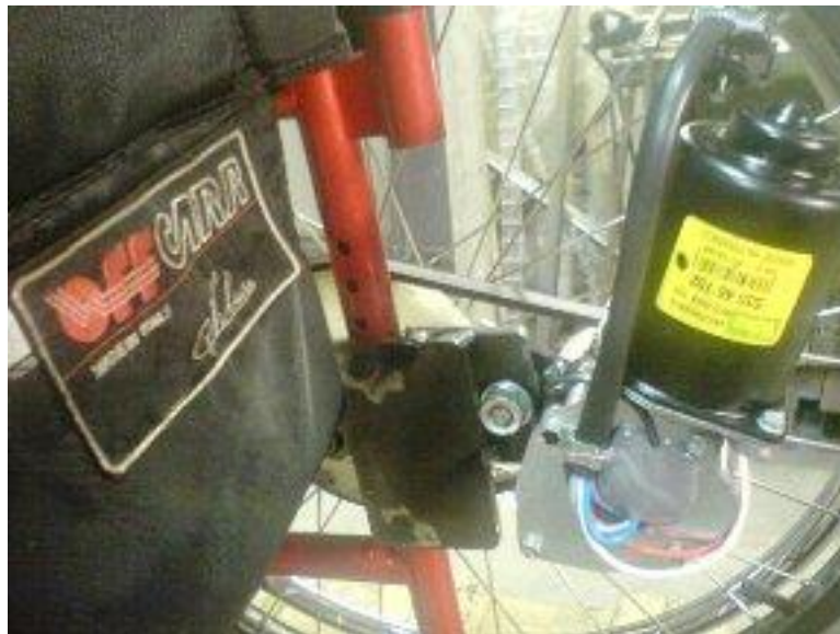
Fig. 14 Optichair I, flangiatura meccanica del motore di destra.
