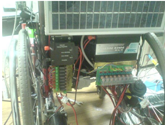
Fig. 36 pannello solare montato posteriormente nel prototipo.
