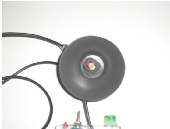
Fig. 117 apparato sensoriale del dispositivo blinker, e' una foto resistenza inserita in una ventosa.
