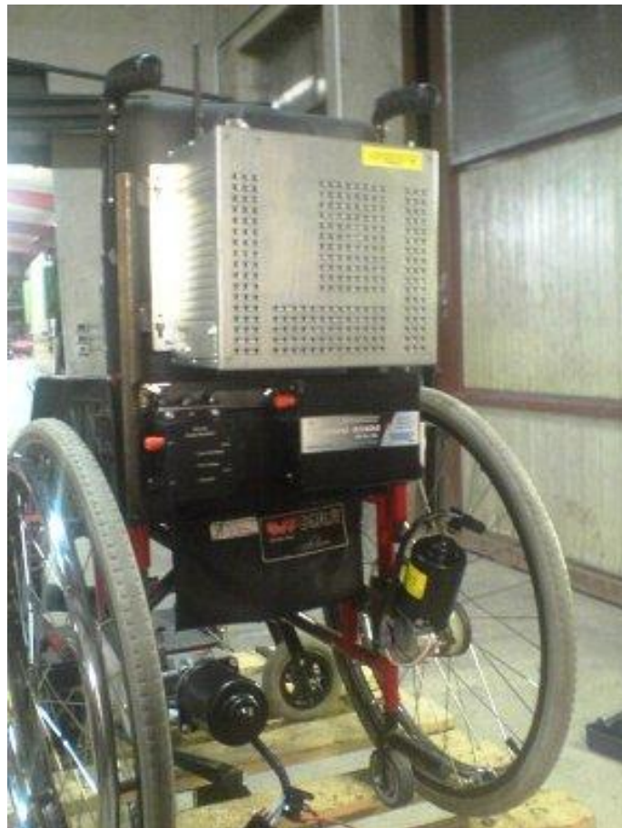
Fig. 18 installazione del computer principale di bordo e sistemi elettronici principali di alimentazione
