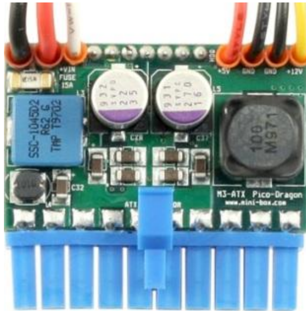
Fig. 54 M3-ATX Pico-Dragon DC/DC converter per alimentazione computer principale.
