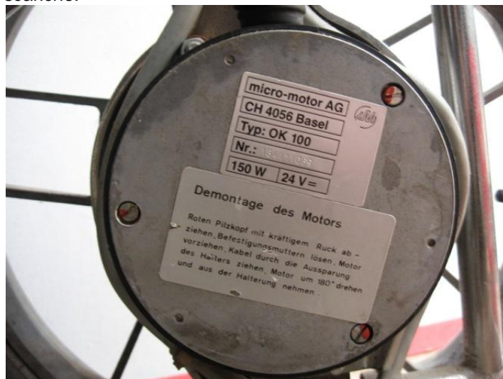
Fig. 40 uno dei due motori di Optichair II
