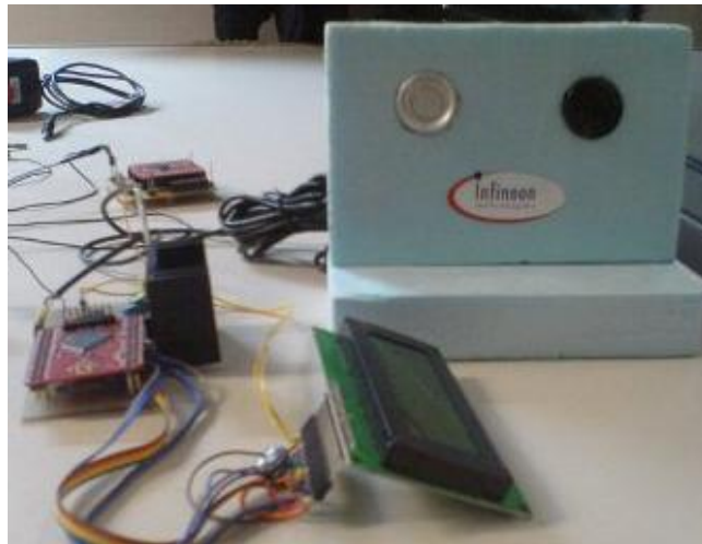
Fig. 145 Telemetria primaria sviluppato con microprocessore infineon.
