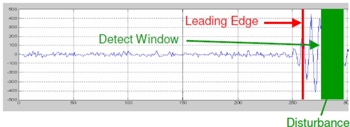
Fig. 5.17: Rappresentazione grafica del funzionamento dell'algoritmo di individuazione Detect 2 sul segnale da analizzare. Il disturbo viene cercato nelle area di Detect (verde) ad una certa distanza dalla leading edge calcolata tramite un algoritmo di LED.
