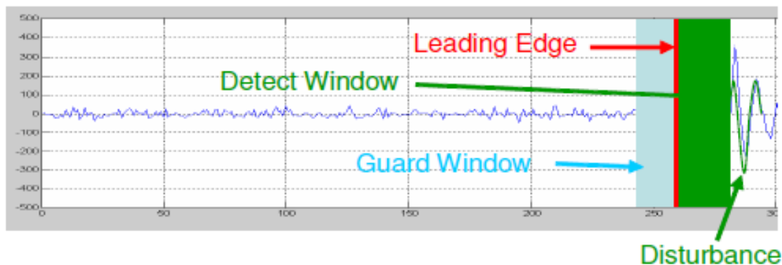
Fig. 5.13: Rappresentazione grafica del funzionamento dell'algoritmo di rilevamento Detect 1 sul segnale da analizzare. Il disturbo viene cercato nelle aree di Guard (azzurra) e di Detect (verde) a cavallo della leading edge calcolata tramite un algoritmo di LED.
