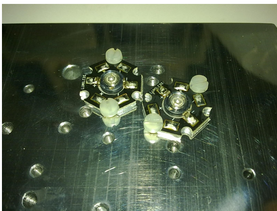
figura 4.4: due led posizionati sulla piastra, a destra con il bordo del coperchio del contenitore, necessario per fissare il contenitore alla piastra
