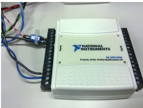
figura 5.1: scheda di acquisizione dati National Instruments NI USB-6008
