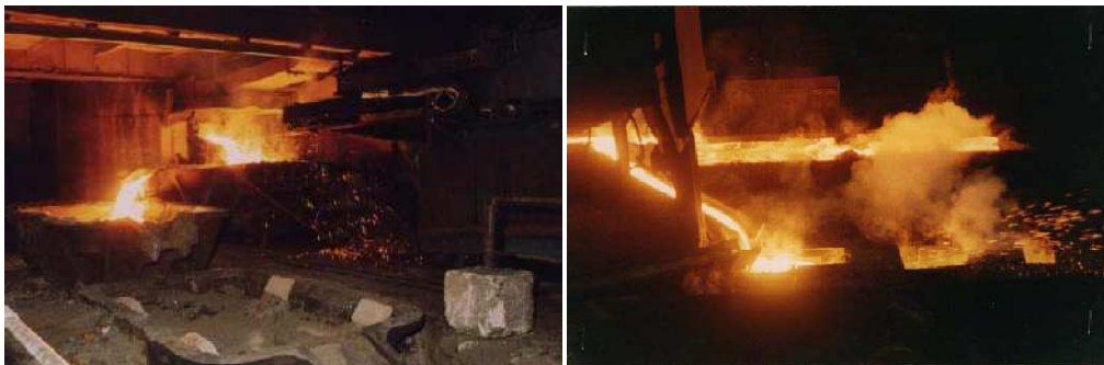
Fig. 2.12 – Riempimento di siviere e vasche con ferrolega.
