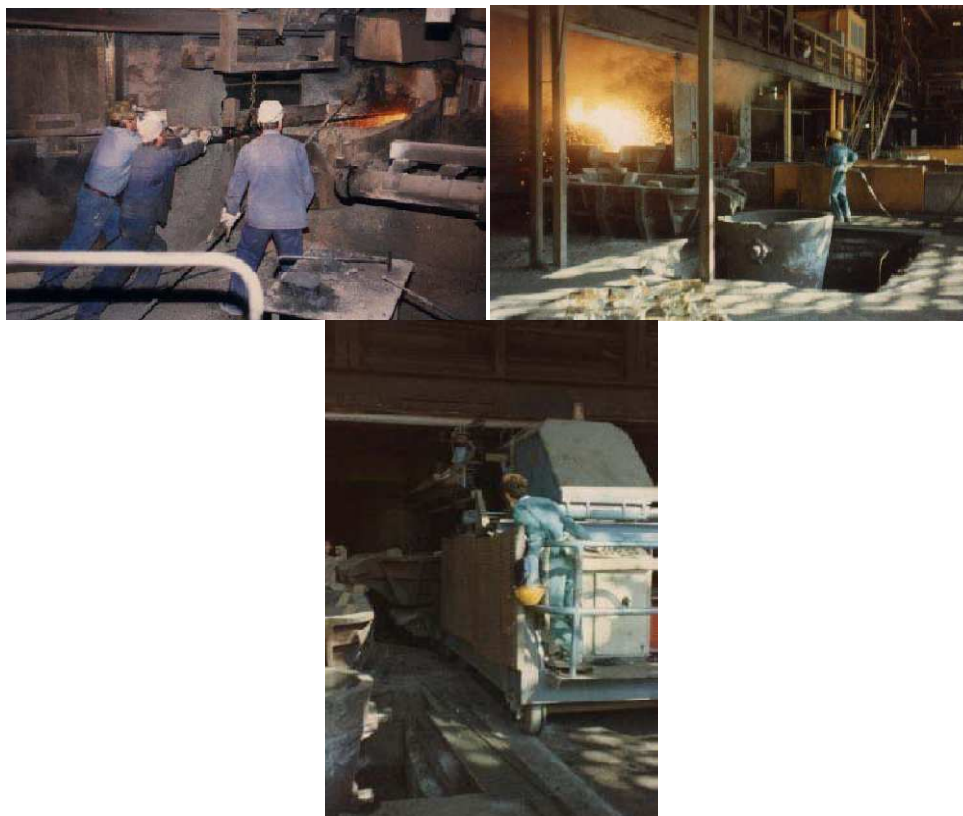
Fig. 2.11 – In alto a sinistra: bussaggio con perforatore. In alto a destra: bussaggio con lancia ad ossigeno. In basso: bussaggio con perforatore montato su macchina operatrice.
