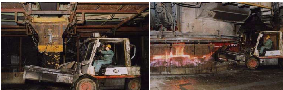
Fig. 2.10 – A sinistra: prelievo della carica. A destra: disposizione nel forno.
