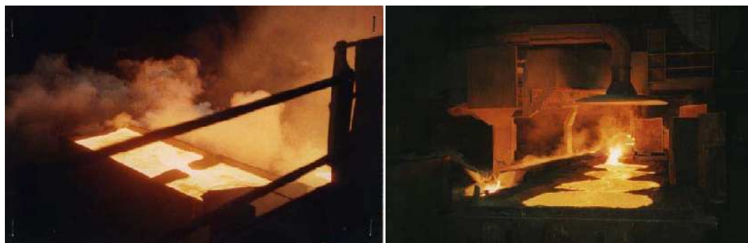
Fig. 2.15 – A sinistra: vasca di raccolta della ferrolega. A destra: vasca di raccolta con cappa per l'aspirazione dei fumi.
