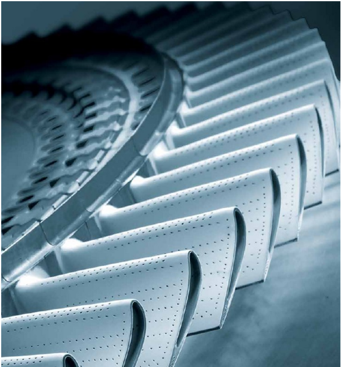
Figura 22: palette con rivestimento TBC e sistemi di raffreddamento
