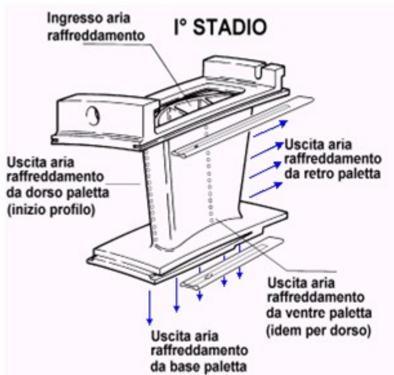
Figura 6: raffreddamento a film del primo stadio della turbina
