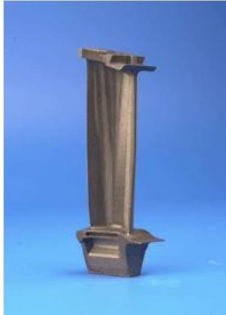
Figura 26: paletta con solidificazione direzionale
