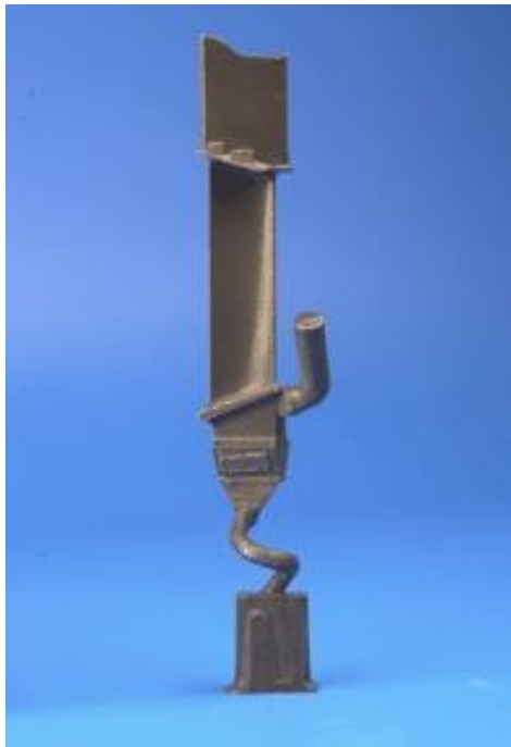
Figura 28: paletta con solidificazione monocristallina
