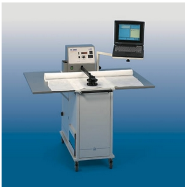
Figura 3.2.4: TEXTEST Air FX 3.300, strumento per la misura della permeabilità all'aria.
