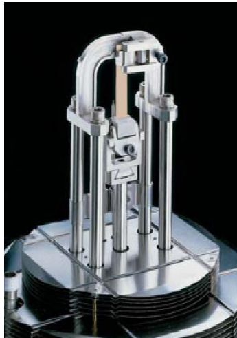
Figura 3.2.3: Clamp per la tensione di film
