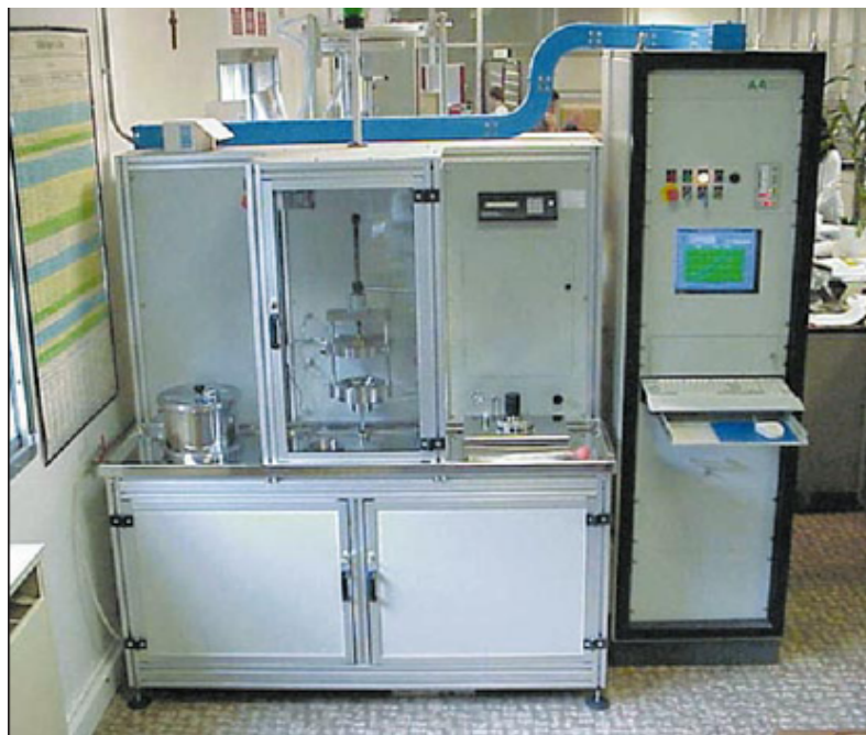
Figura 3.2.5: Banco di prova per l'efficienza filtrante
