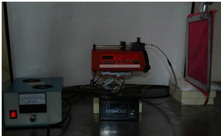
Figura 3.1.11: Apparecchiatura per l'elettrospinning
