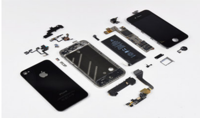
Figura I.2: Struttura interna dell' iPhone 4 della Apple.
