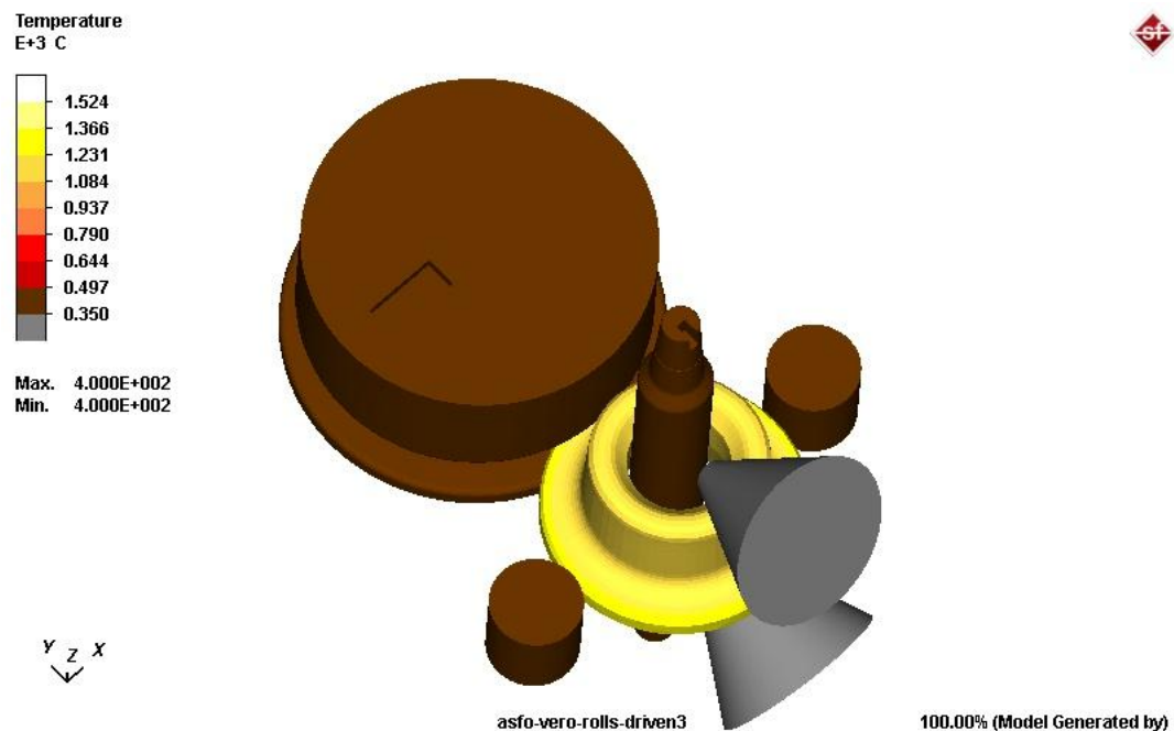
Figura 3.8: Mappe di temperatura del laminatoio e dell'anello ad inizio simulazione.
