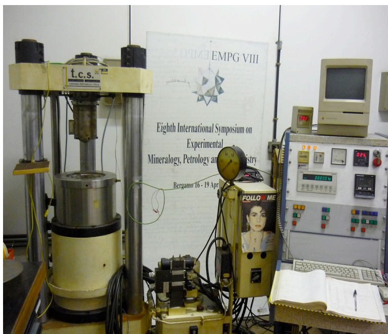
Fig 4.2 Piston cylinder utilizzato per l'esperimento di rifusione delle inclusioni a pressione controllata presso il Dipartimento di Scienze della Terra, Università di Milano.
