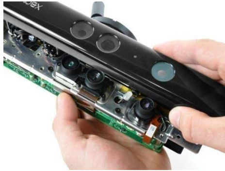
Figura 2.4: Sensori di Kinect che consentono la rilevazione delle immagini e della profondità
