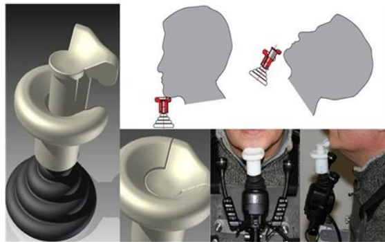
Figura 1.1: Joystick comandato con i movimenti del mento o delle labbra
