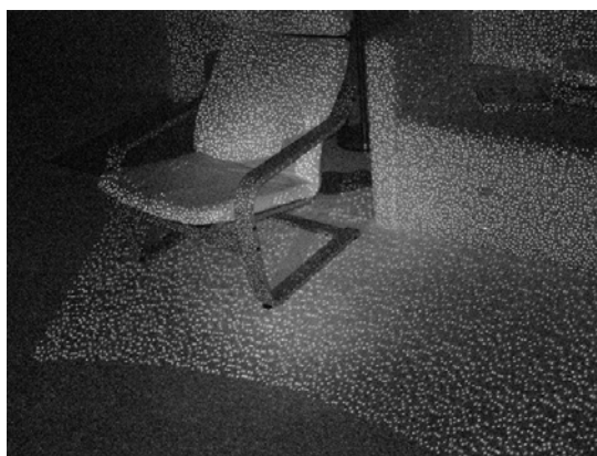
Figura 2.7: fascio di infrarossi proiettato dal Kinect
