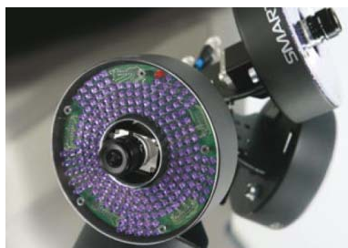
Figura 2.4 Telecamera (ed emettitore) infrarosso con sensore CCD del sistema BTS SMART. [54]
