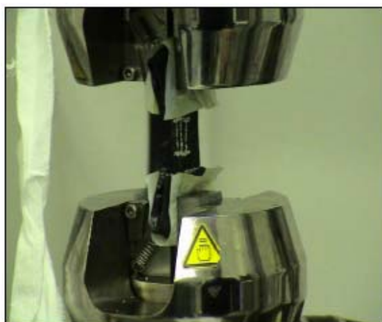
Prova statica di trazione su nastrino
