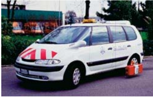
Fig. 1. Ecodyn per la simulazione e misura della visibilità della segnaletica (RL) da una distanza di 30 m.
