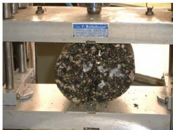
Figura 19: Rottura di tipo duttile
