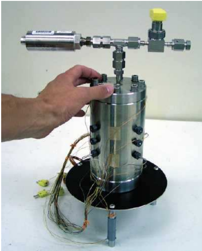
Figura 9. prototipo di serbatoio per idruri metallici sviluppato al dim dell'Università degli Studi di Padova. Fonte: "www.dim.unipd.it"
