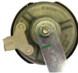
Figura 8 Avvisatore acustico modello "Klaxon"
