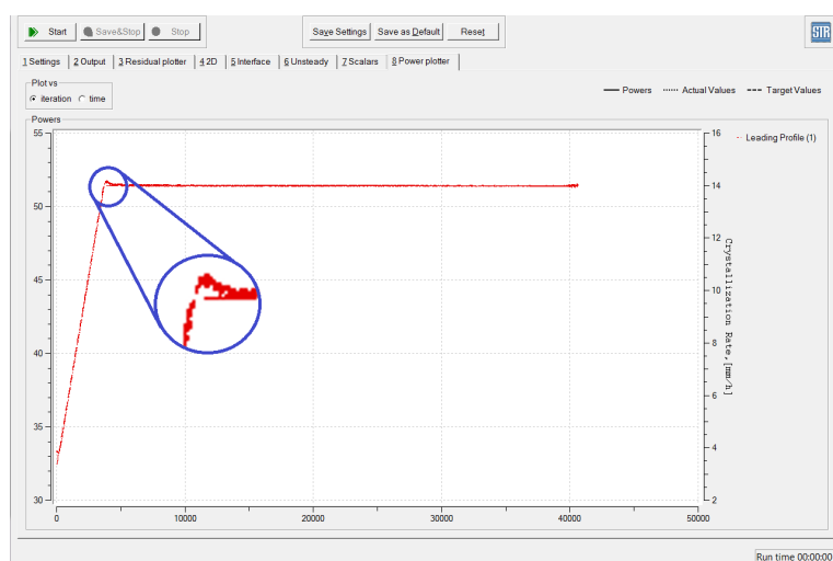
Figura 8.0.3: Funzione obiettivo e andamento calcolato, si evidenzia il picco determinato da fattori di inerzia termica del forno.
