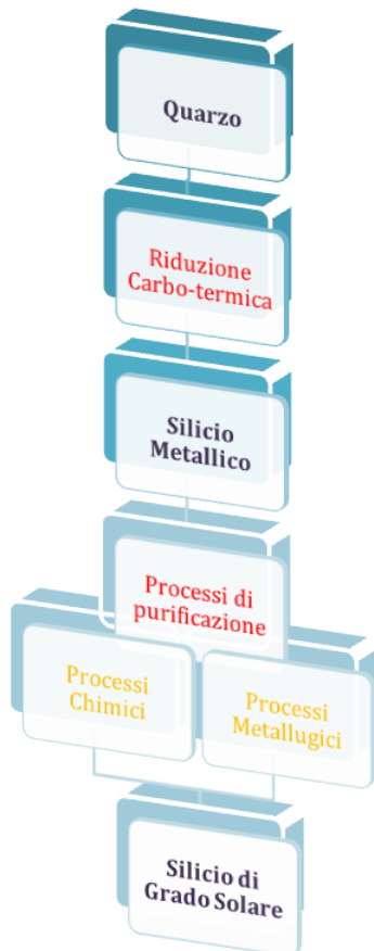
Figura 5.2.1: Sequenza delle fasi di lavorazione del silicio.
