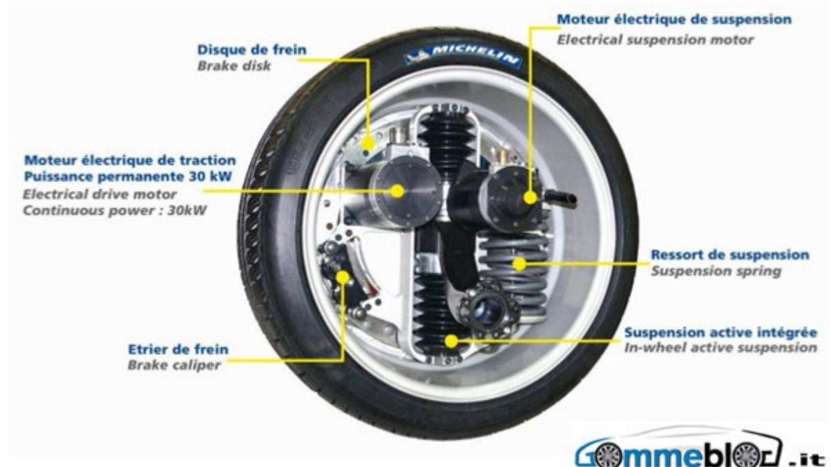
Figura 13. Componentistica di motori "in wheel".
