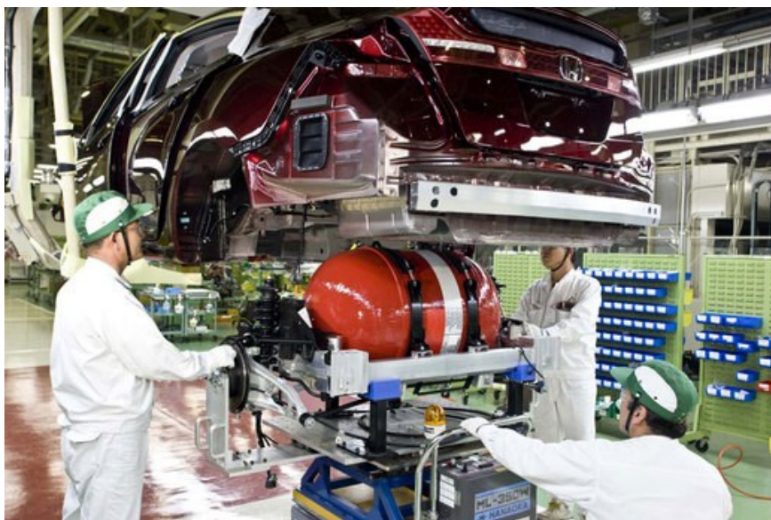
Figura 7. Esempio di montaggio serbatoio e componentistica in un prototipo ad idrogeno.
