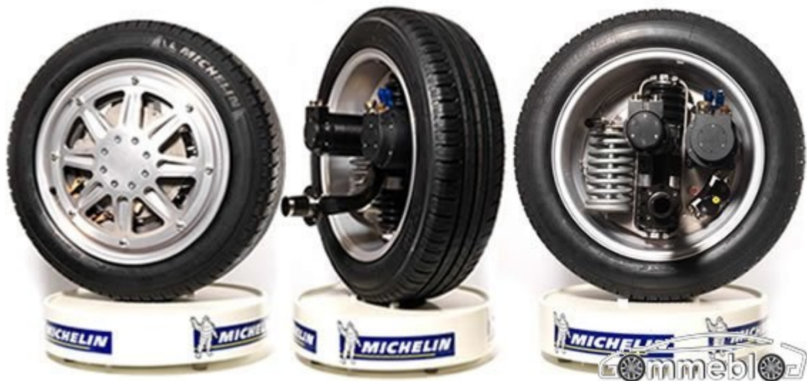
Figura 12. Rappresentazione di motori elettrici “in wheel”.
