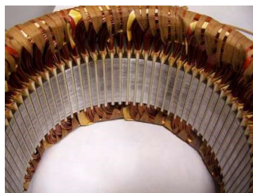
Figura 21. Esempio di uno statore con i suoi avvolgimenti di rame.
