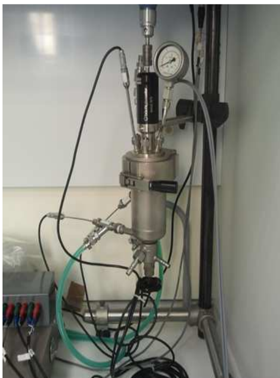
Figura 4.1 Reattore batch incamiciato da 0.25 l.
