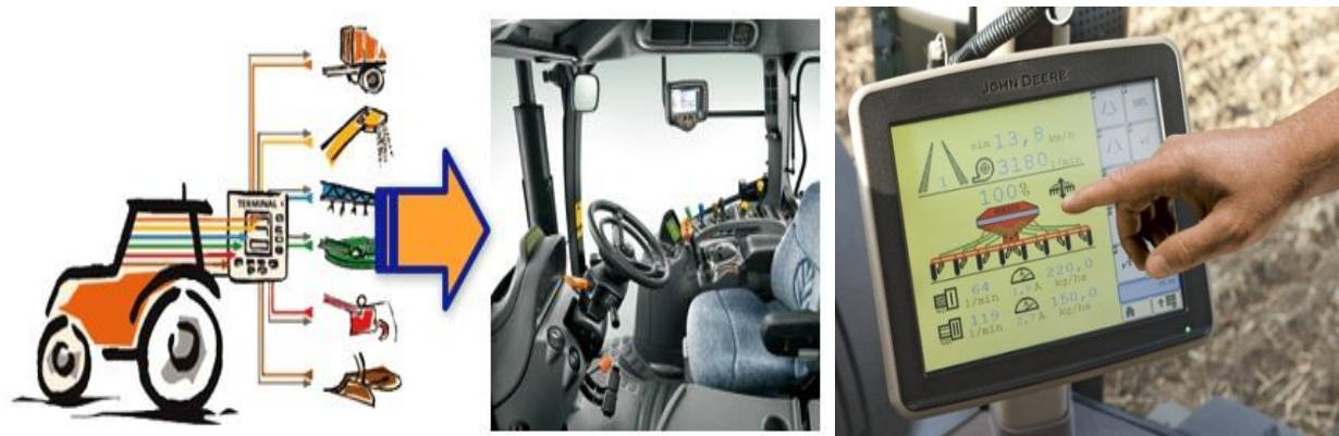
Fig.11 a sinistra: Schema del funzionamento di ISOBUS ed esempio di cabina con computer di bordo (Virtual Terminal) di un trattore. Fig. 12: a destra, Virtual Terminal della John Deere, i dati del trattore e le mappe di prescrizione vengono caricate sul monitor tramite una memory card.
