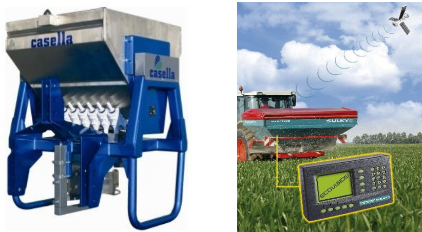
Fig. 14: Modelli di spandiconcime a dosi variabili con pesatura automatica: offrono la possibilità di distribuire dosi variabili di prodotto in accordo con una mappa di distribuzione opportunamente elaborata. Il funzionamento si basa sul confronto tra la mappa e la posizione in campo determinata da un ricevitore GPS, unitamente alle prescrizioni agronomiche contenute in un file (dosi da erogare per ciascuna classe della mappa).
