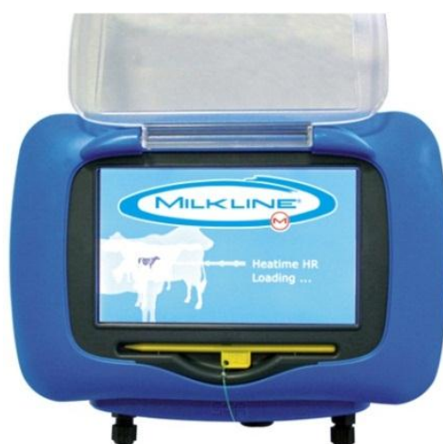
Fig. 13: Monitor per la rilevazione di dati rilevanti la salute degli animali: il sistema si compone di collari specifici (da applicare agli animali sulla parte superiore sinistra del collo bovino) i cui segnali inviati tramite infrarosso all'antenna e quindi trasmessi al PC consentono, attraverso uno specifico software, di ottenere un'ampia gamma di elaborazioni e di risoluzioni grafiche di facile lettura ed acquisizione.
