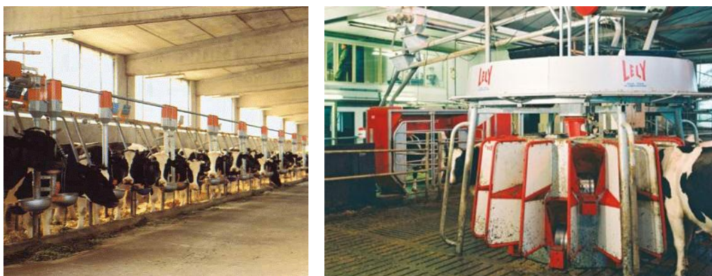
Figura 8: Esempio di sistemi di alimentazione automatico: a sinistra sistema di distribuzione in una posta fissa montato sulla singola rastrelliera, mentre a destra, box di alimentazione automatica con stabulazione libera.
