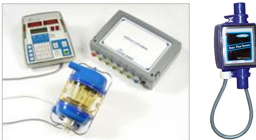
Fig.4: Due modelli di lattometri: il primo misura la quantità e la conducibilità elettrica del latte prodotto da ogni bovina, insieme con il tempo totale di mungitura ed il flusso di eiezione del latte;
