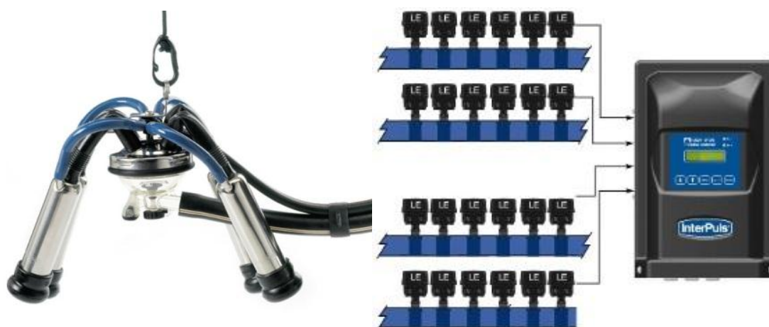
Fig. 5: a sinistra un modello di collettore di nuova generazione: garantisce un'elevata capacità di scarico del latte munto senza generare turbolenze, quindi schiuma, assicurando la stabilità del livello di vuoto. La regolarità delle superfici interne del collettore garantiscono una pulizia ottimale; la coppetta trasparente è costruita in materiale plastico alimentare resistente agli agenti chimici oltre che alle alte temperature. La forma ergonomica ne garantisce la maneggevolezza.
