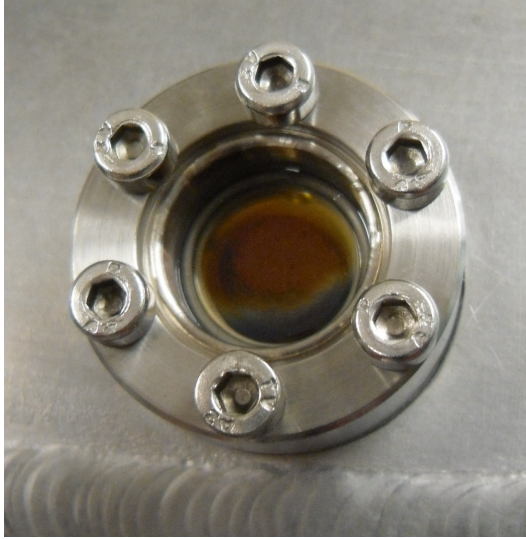
(a) Finestra sporca montata sulla camera
