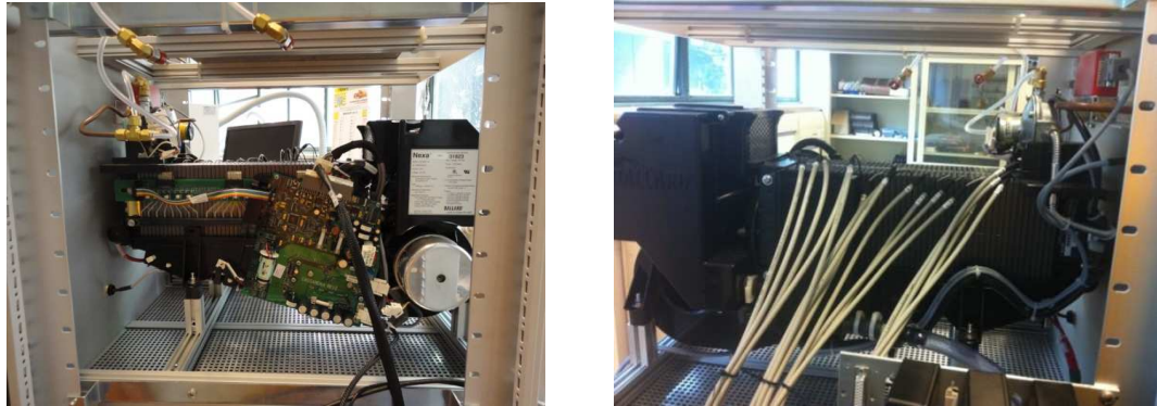
Figura 4.15 - Stack Ballard inserito nel sistema Nexa; nell’immagine a destra sono visibili i connettori inseriti tra i bipolar plates per l’acquisizione delle tensioni delle celle.
