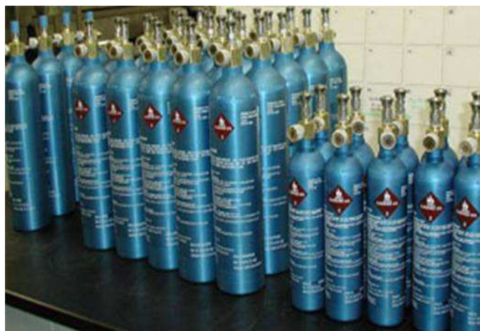
Figura 3.4 - Serbatoi per lo stoccaggio in idruri metallici (Ovonic).
