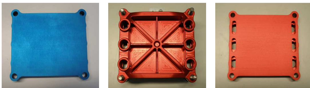
Figura 4.19 - Da sinistra a destra: endplate lato anodo; endplate lato catodo, faccia con le connessioni; endplate lato catodo, faccia con l'ingresso dei fluidi.
