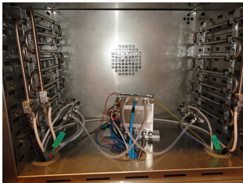
Figura 7.16 – Montaggio completo dello stack nella camera termostatica.
