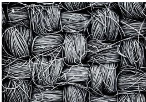
Figura 2.6 – GDL composto da tessuto di carbone.
