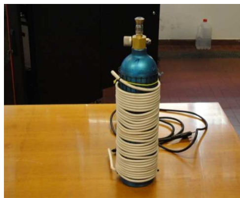
Figura 4.6 – Canister avvolto nella termoresistenza.
