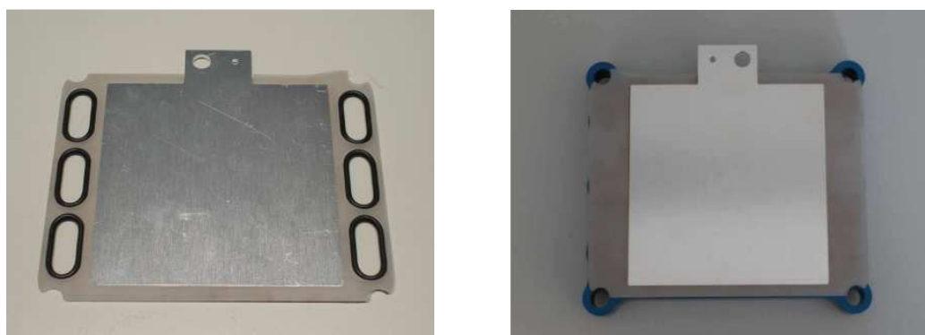
Figura 4.20 - Collettore di corrente catodico (a sinistra) e anodico (a destra).
