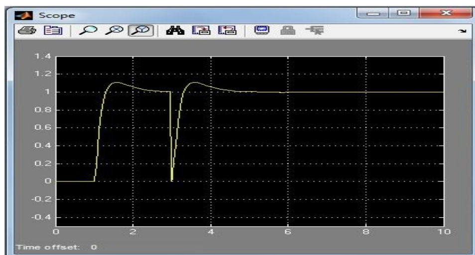
Figura 4.3.b: Grafico dell'uscita del sistema sollecitato dal disturbo applicato a valle del sistema motore
