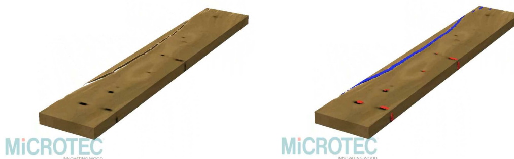
Tavola crepata e piena di nodi prima e dopo dell'evidenziazione delle imperfezioni..
