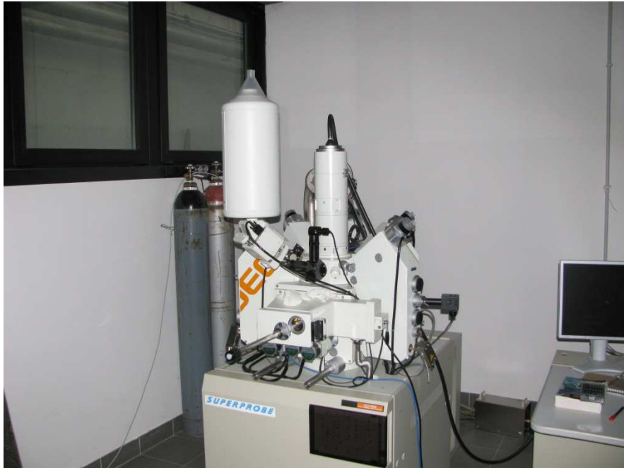
Figura 2: microsonda Jeol JXA 8200 SuperProbe, INGV Roma
