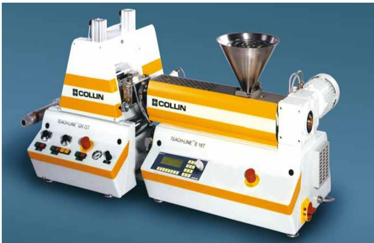
Figura 1.3: esempio di configurazione estrusore-calandra
