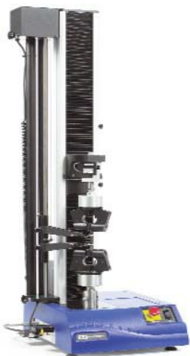
Figura 1.8: dinamometro instron usato per eseguire le prove di trazione
