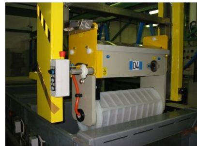
Figura 2.4. impianto con due rotogalvani sospesi a un carro-ponte; a destra foto di un rotobarile che sta per essere immerso in una vasca.
