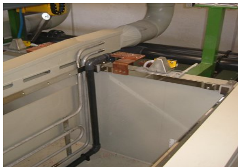
Figura 2.1. esempio di vasca usata nelle lavorazioni galvaniche; nella foto a destra si vedono una serpentina per riscaldare la soluzione di processo e le cappe di aspirazione in grado di captare tutti i fumi e preservare, in questo modo, l'ambiente di lavoro.
