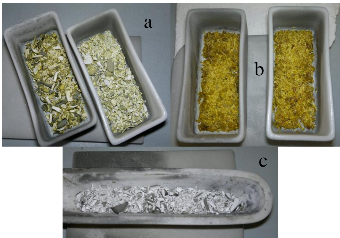
Figura 5. 7: a) Geh:Eu-NC e Geh:Eu (da sinistra), trattamento a 1300°C in N 2 ; b) Geh:Eu-NC e Geh:Eu (da sinistra), trattamento a 1400°C in N 2 ; c) Campione Geh, trattamento a 1300°C in N 2 .
