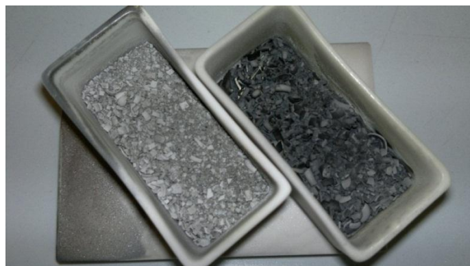
Figura 5. 25: Campioni MS:Eu e DS:Eu (da sinistra) dopo trattamento a 1300°C in azoto.
