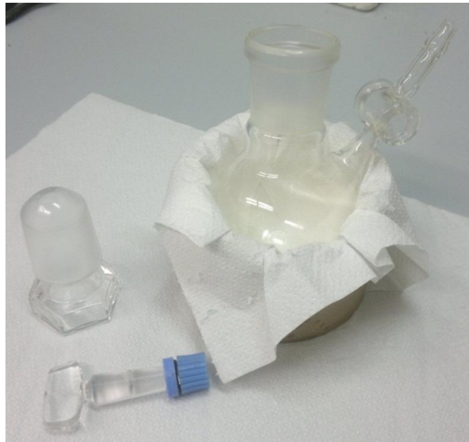
Figura 4. 1: Palloncino di vetro su supporto di cartone, con tappo e rubinetto.
