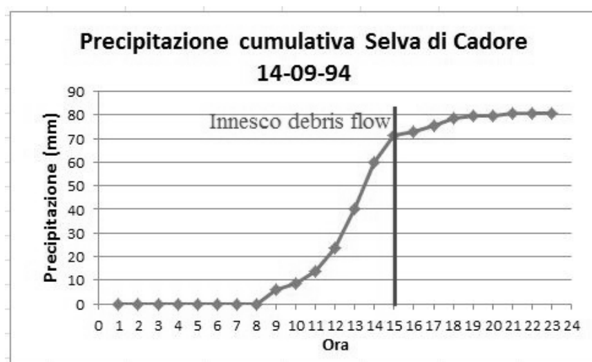
fig. 2.2.8 – Grafico di precipitazione cumulativa, realizzato a partire dai totali di precipitazione oraria. Dati ARPAV.
