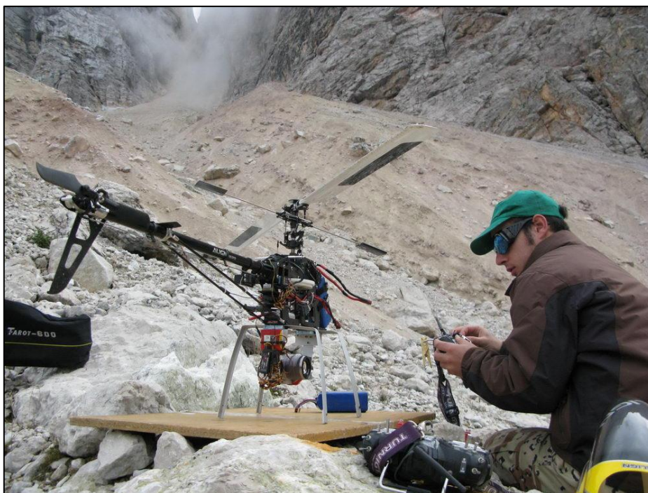
Fig. 3.1.2 – L'elicottero radiocomandato Tarot 600 utilizzato per la fotogrammetria aerea. Al di sotto del drone è montata la fotocamera Sony NEX 5N.
