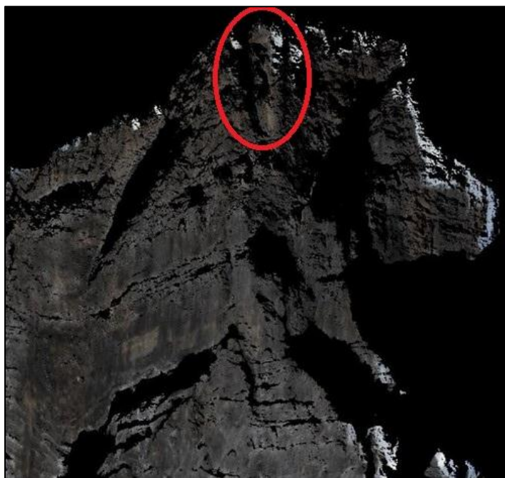
Fig. 2.1.5 – Nuvola di punti con sovrapposizione di una foto. Scansione della parete settentrionale del Monte Pelmo con laser scanner terrestre svolta a fine gennaio 2012. Col cerchio rosso è indicata la nicchia di distacco del crollo.
