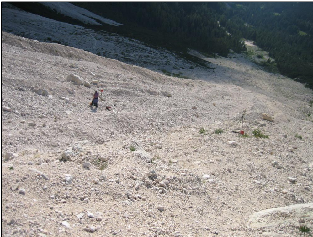
Fig. 3.1.1 – Rilievo fotogrammetrico terrestre del debris flow del 1994. Sono state scattate delle foto ad intervalli di qualche metro dagli argini del canale, puntando l'obiettivo sulla sponda opposta e al centro del solco dove sono stati posizionati i target per la georeferenziazione.
