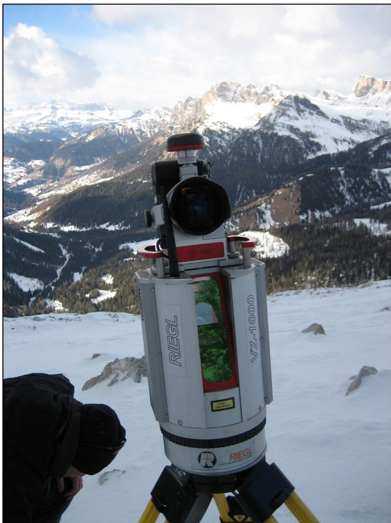
Fig. 3.3.3 – Il laser scanner terrestre RIEGL VZ-1000 utilizzato per il rilievo. Si nota lo specchio per indirizzare l'impulso, la fotocamera digitale integrata Nikon D-700 e il GPS integrato.
