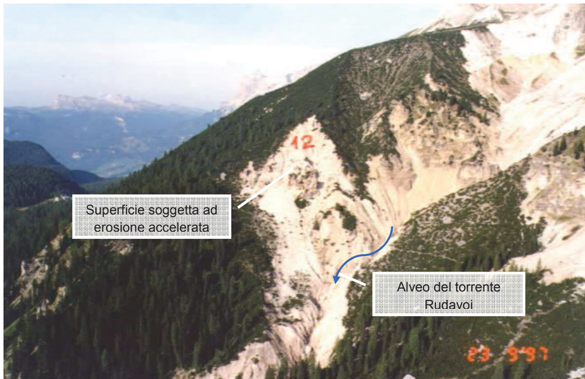
Fig. 4.20 - Panoramica della zona franosa in destra idrografica (foto: Fenti V., 1997).
