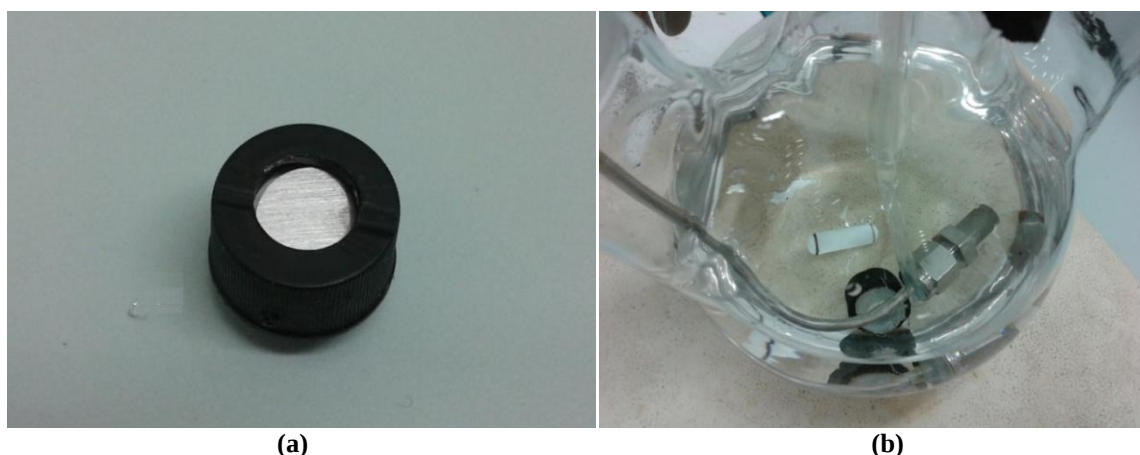
Figura 2.3: Disco di palladio nel porta campione (a) ed inserito nel sistema di reazione (b).
