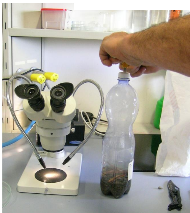
Alle bottiglie schiacciate (per fare fuoriuscire l'aria) è stata insufflata la CO 2 , mediante una bomboletta e apposito erogatore regolabile.
