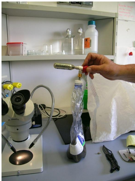
Alle bottiglie schiacciate (per fare fuoriuscire l'aria) è stata insufflata la CO 2 , mediante una bomboletta e apposito erogatore regolabile.
