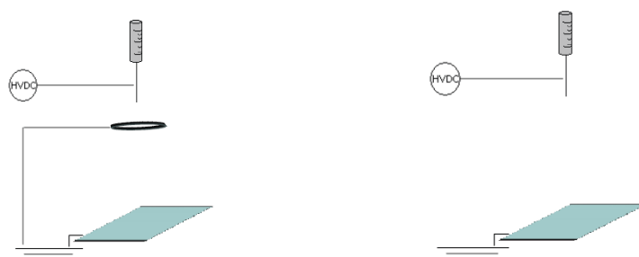
Figura 3.8 Schema dell'impianto di elettrospraying con elettrodo aggiuntivo (sinistra) e senza elettrodo (destra)
