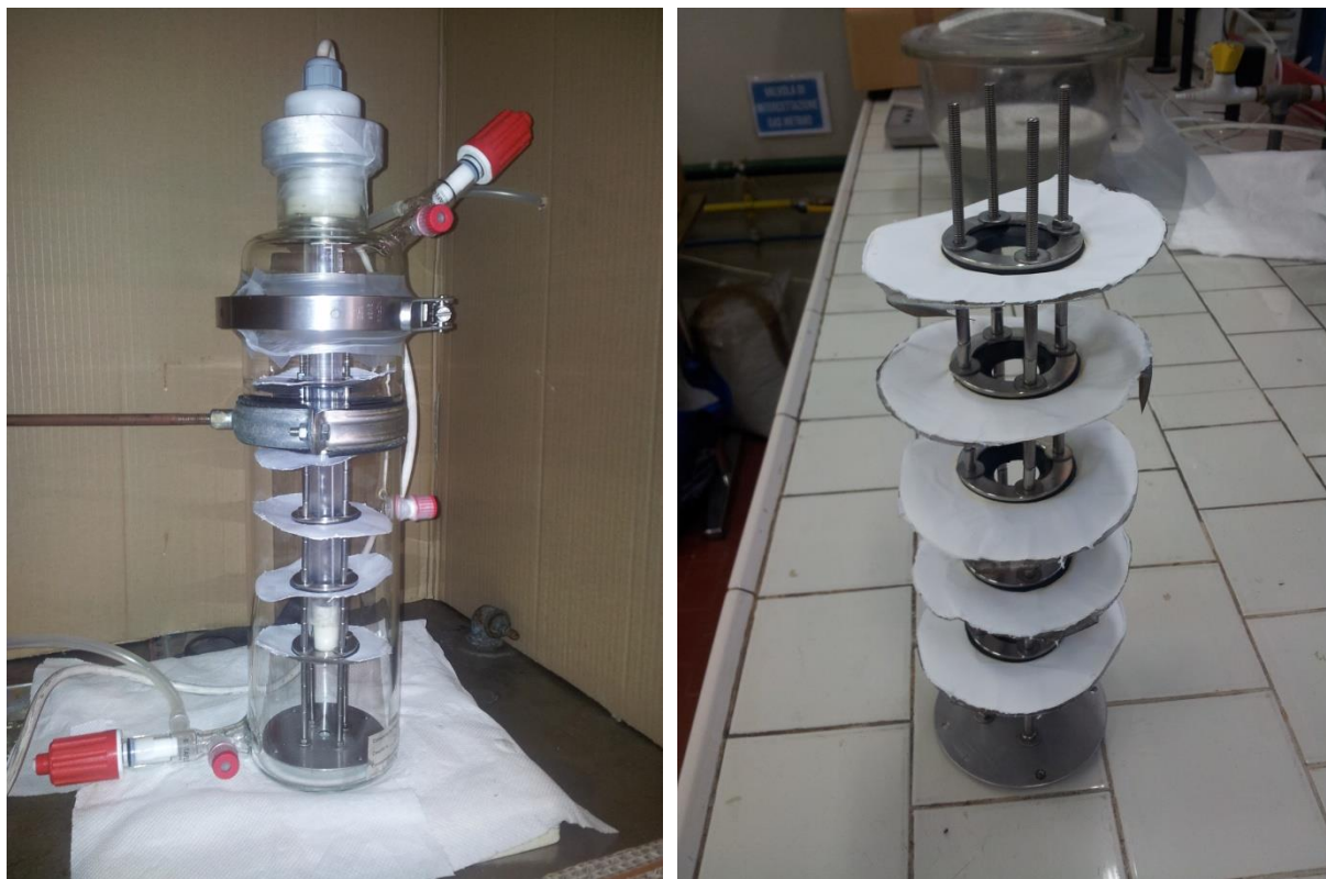
Figura 5.2 (a) Reattore utilizzato per i test e (b) particolare del castelletto con le membrane inserite
