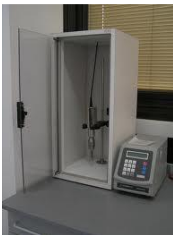
Figura 3.6 VC505 ® prodotto dalla Sonics Vibra-Cell
