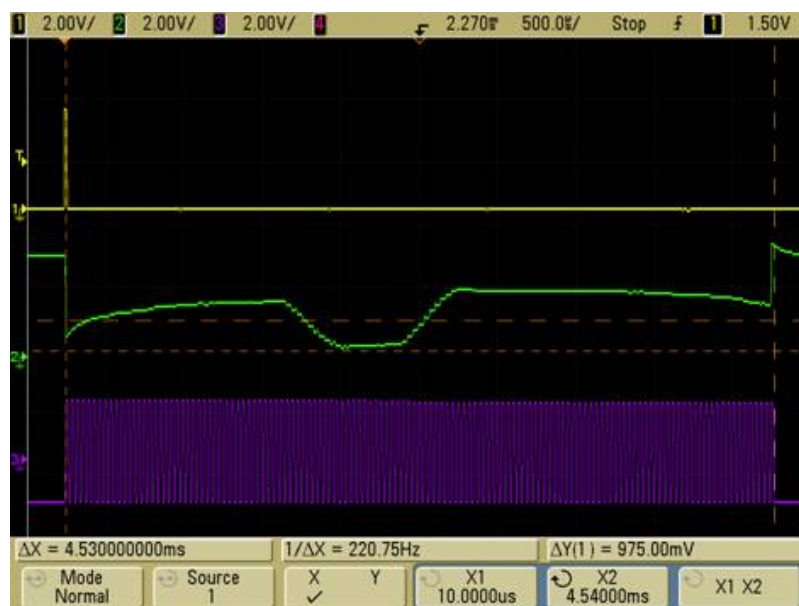
Figura 2.10: Segnale AO della camera puntata verso la linea nera visto in un DSO.
