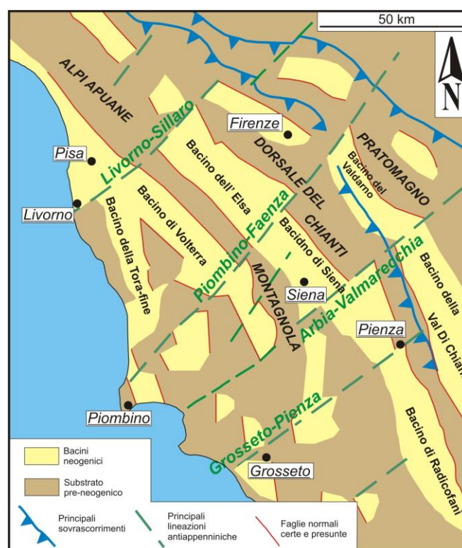
Fig. 5 : Distribuzione dei bacini neogenici e quaternari e dei principali lineamenti antiappenninici nel settore interno dell'Appennino Settentrionale (da Martini e Sagri, 1993, modificato).
