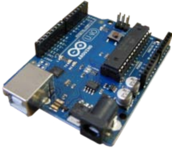
Figure 4.2: Scheda Arduino Uno
