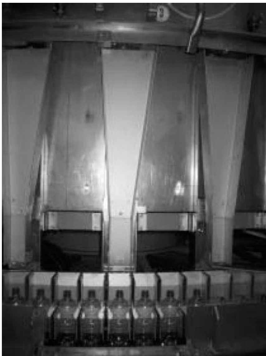
Fig. 5.20 – Particolare della canale inferiore e superiore di caduta della bottiglia
